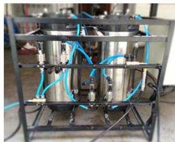
A Unidade de Reabastecimento Automático da UMICONTROL, é composta por até dois tanques de pressão, onde o comando de alimentação dos tanques e liberação de fluido para o sistema é realizado de maneira automatizada através de painel elétrico com Controlador Lógico Programável.
